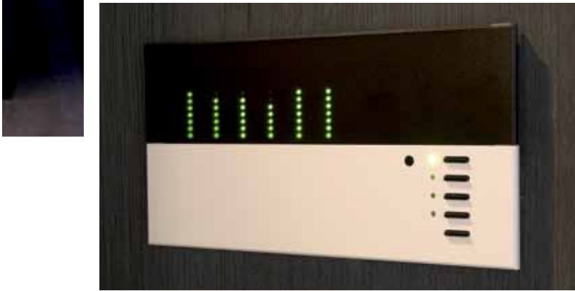
Die Lutron Grafik Eye Lichtsteuerung regelt für bis zu sechs Kanäle die Beleuchtung im Kinoraum und sorgt so für authentische Atmosphäre.
