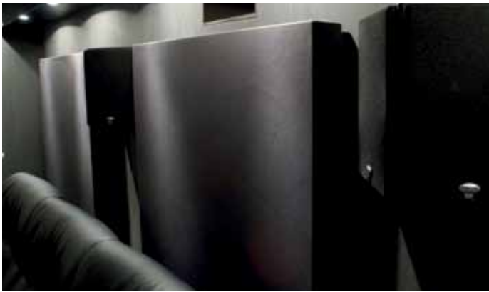
Die THX-Ultra-zertifizierten Dipole von Klipsch (KS-525) sorgen als Surround-Lautsprecher für diffusen Raumklang von hinten.
